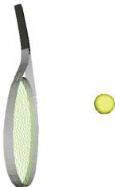
Finit element (FE)-beräkning som visar rackets ändläge efter det att bollen träffat racketen med en hastighet av 32.5 m/s.
