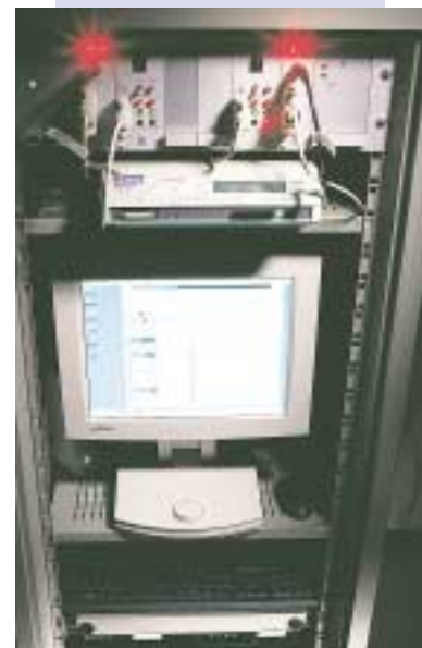
S. Fröken Ur styrs av ett cesiumur vars periodtid definierar enheten sekund.
