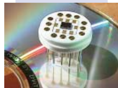
... dels den kända resistansen (ca 6,4 eller 12,9 kohm) över en halvlederplatta genom den kvantiserade Hall-effekten.
