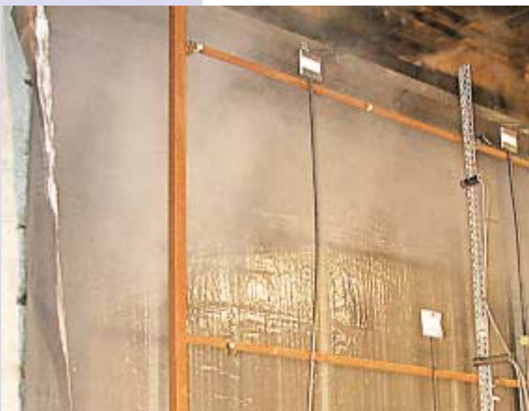
Förångning av vatten i ovkant av en brandgardin. Med en relativt sett liten vattenmängd kan brandskyddet ökas väsentligt.
