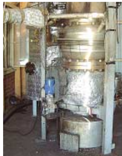
Nedre delen av gengasgeneratorn där förbränningen sker. Ytterligare utvecklingsarbete återstår innan gengasverk kan drivas övervakningsfritt.
