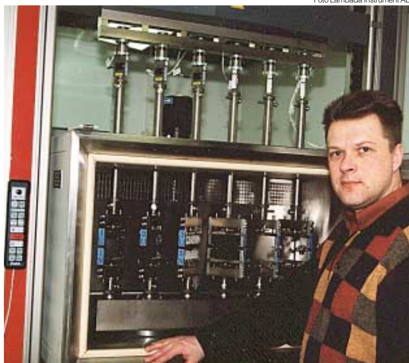
I utrustning som SP nyligen införskaffat kan många material och produkter t.ex. tryck-, drag-, kryp- och relaxationsprovas.
