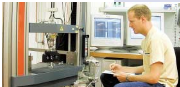
En nyligen införskaffad universalprovningssmaskin gör det möjligt att utföra mekaniska provningar där töjningen mäts med video.
