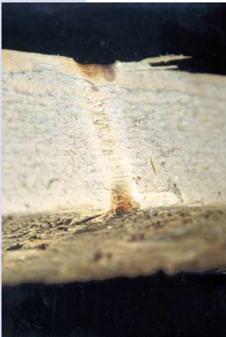
SP:s medverkan i en polisutredning bidrog till att ett svårlöst mordfall kunde klaras upp. Prov utförda på en träbjälke visade att kvinnan inte kunde ha begått självmord genom hängning. Träbjälken sedd uppifrån med intryckningar från repet. Notera att ytan vid kanterna är mörkfärgad och svagt glänsande.
