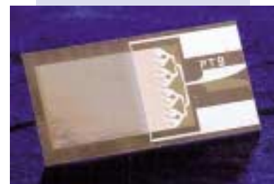
A. Enheten ampere förverkligas genom dels en kedja av seriekopplade Josephsonövergångar med känt spänningsvärde (upp till ca 10 V), ...
