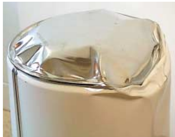
Fallprov. Rotationssymmetri har utnyttjats för att modellera halva burken. Verifieringen av FE-modellen visar att samma bucklingsfenomen uppträder runtom på randen av burken och att deformationen överensstämmer bra med verkligheten.
