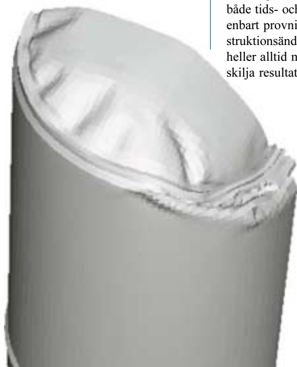
Fallprov. Rotationssymmetri har utnyttjats för att modellera halva burken. Verifieringen av FE-modellen visar att samma bucklingsfenomen uppträder runtom på randen av burken och att deformationen överensstämmer bra med verkligheten.
